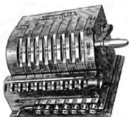
Рис. 3.10. Серийный арифмометр, выпущенный на заводе В.Т. Однера в Санкт-Петербурге
